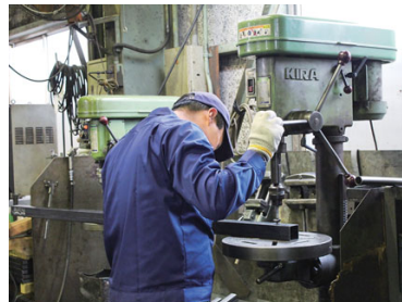
ボール盤を使って穴あけ加工(鶴田工業所)
